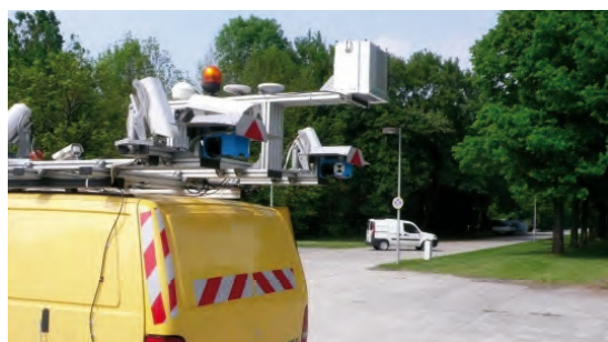
Der Laserscanner ist kaum größer als ein Schuhkarton (Bildquelle: 3D Mapping Solutions)
