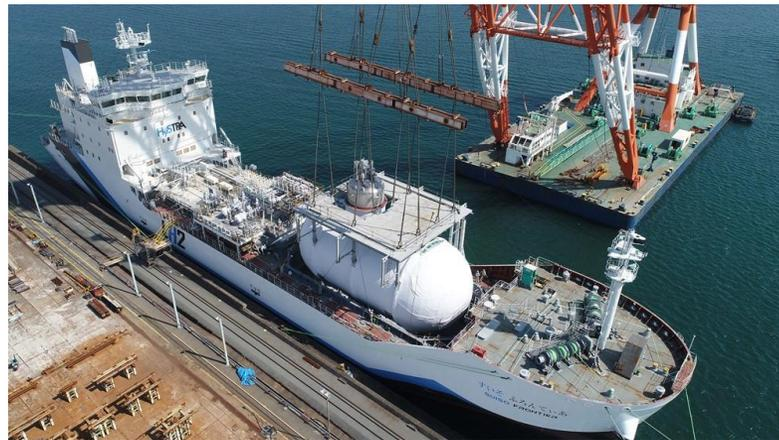
Suizo Frontier Erste Flüssigwasserstoff Tanker
