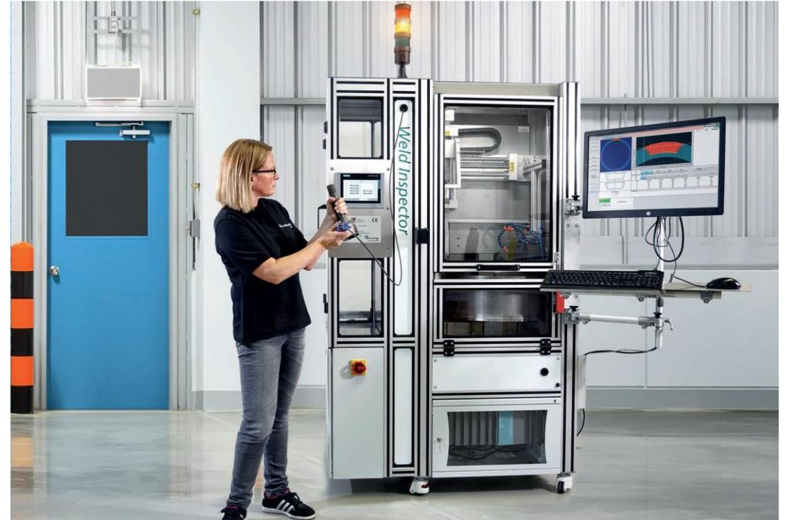
Teilautomatisierte Anlage zur Vermessung der Schweißnahtgeometrie von Abtriebswellen für das 8-Gang-Pkw-Automatikgetriebe der ZF Friedrichshafen AG, Werk Saarbrücken
